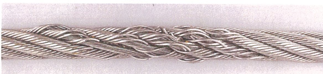
(b) ロープグリース除去後 写真1 最多断線部の外観 (15m地点)
