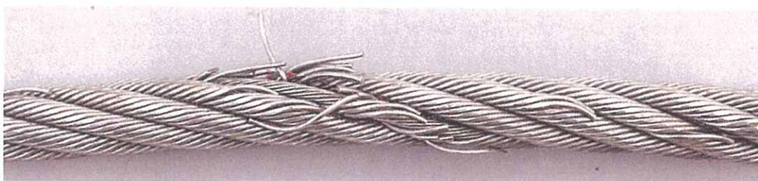
(b) ロープグリース除去後 写真2 最多断線部近傍のロープ外観 (16m地点)
