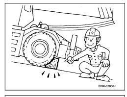
輪止めをする際、ブレーキロック(作業用補助制動装置) を使用することで、より強い制動力が得られ、より安全 に作業が行えます。
