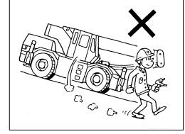
ラフテレーンクレーンの多くのパーキングブレーキは 前軸への入力軸を止めるタイプで、前輪の片側が浮く 状態では接地している側もきかなくなります。 また、アウトリガにより前輪を持ち上げる場合も同様 にパーキングブレーキはきかなくなります。
