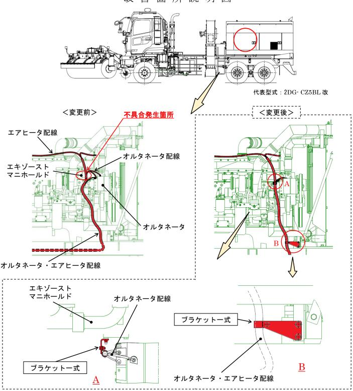
除雪車の電気配線において、作業用エンジンのオルタネータ配線の配索が不適切なため、エンジンエキゾーストマニホールドの輻射熱により配線被覆が溶損するものがある。そのため、そのままの状態で使用を続けると、配線が露出して短絡し、最悪の場合、配線被覆に引火して車両火災となるおそれがある。
