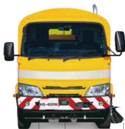
左側ブラシ・片側吸込み 1,190mm 左側ブラシ・両側吸込み 1,930mm
