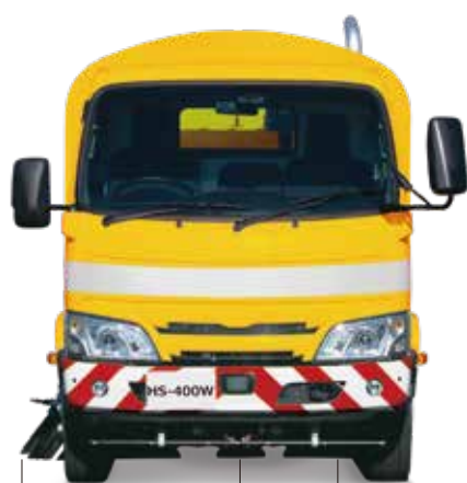
右側ブラシ・片側吸込み 1,190mm 右側ブラシ・両側吸込み 1,930mm
