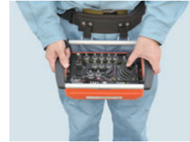
機械本体操作無線送信機 (設置・架設・撤去・搬出作業用)
