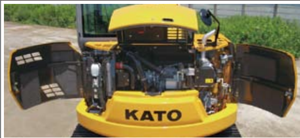
▲外装フルオープンと集中レイアウト。メンテナンス効率大幅改善
