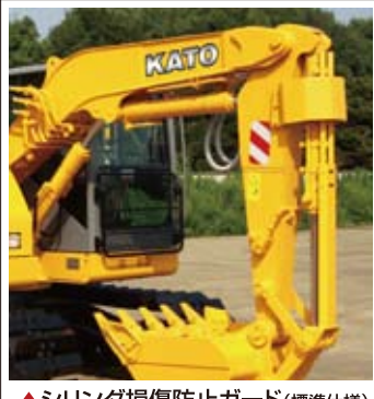
▲シリンダ損傷防止ガード(標準仕様)
