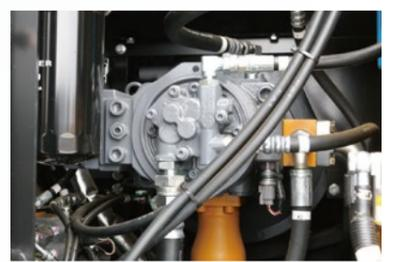
■油圧配管の大径化で圧力損失を低減
