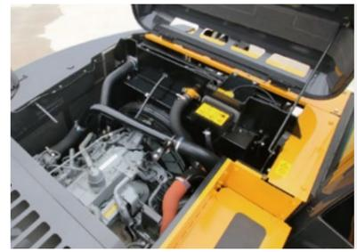
排出ガス後処理システム(SCR)によりNOxを大幅に削減。排出ガスをクリーンにします。
