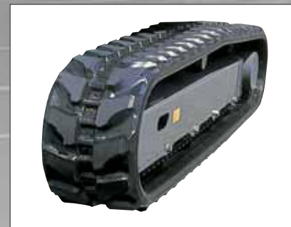
現行ゴムクローラのオーバーラップ構造
