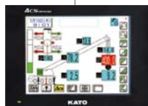
▲クレーン作業用タッチパネル式ディスプレイ
