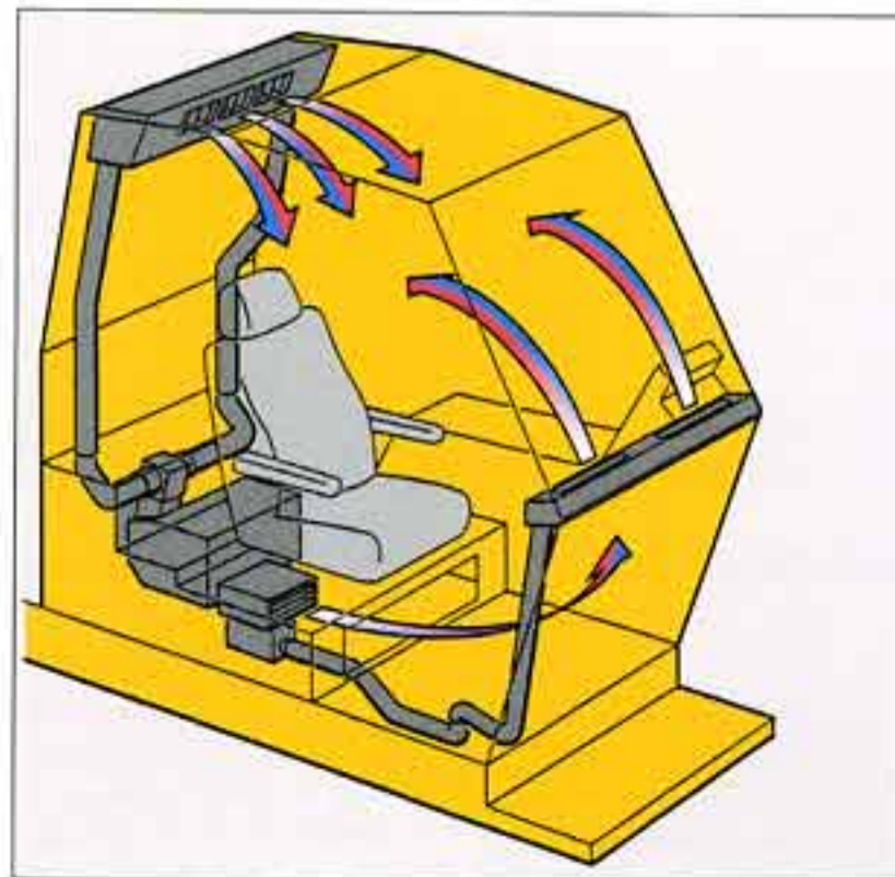
●オールシーズン快適作業を実現するビルトインタイプのエアコン
