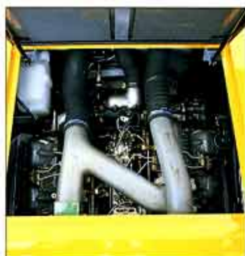
●低騒音、低燃費の高性能インタークーラターボエンジン
