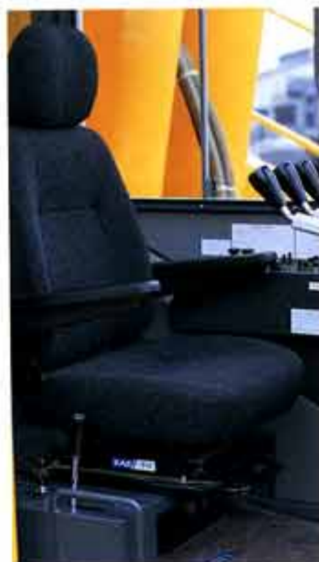
● ひじかけ付チルト機構のフルリクライニングシート
