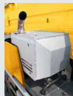
▲キャタライザ (触媒装置)
