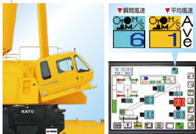
▲チルト式キャビン ▲タッチパネル式カラーディスプレイ
