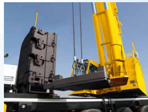
▲カウンタウエイトの組み方例(サイドベースの着脱)
